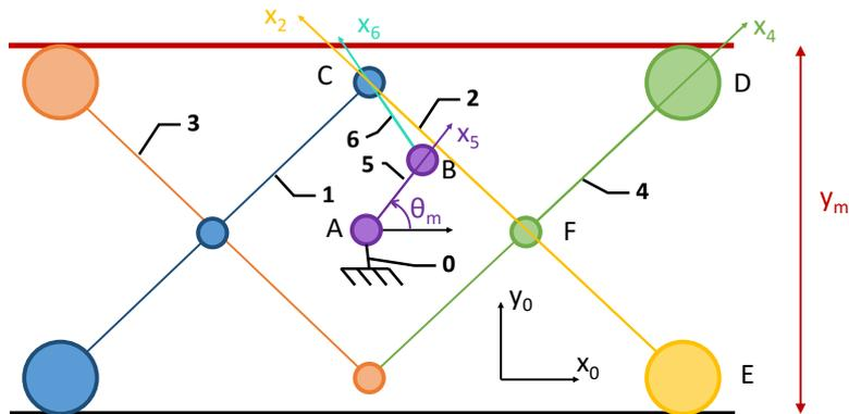
**Question 1 :** Déterminer  $y$  en fonction de  $\theta_m$  et des paramètres géométriques du système, en utilisant la loi de fermeture géométrique. Les dimensions seront mesurées sur le système afin d'effectuer l'application numérique.
